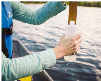
L'échantillonnage de la qualité de l'eau est effectué en utilisant une bouteille fixée sur un porte-bouteille, que l'on descend graduellement jusqu'à 1 mètre sous la surface de l'eau. Quant à la transparence, celle-ci est mesurée à l'aide d'un disque de Secchi. La transparence de l'eau correspond à la profondeur à laquelle le disque n'est plus visible à partir de la surface (MELCC et CRE Laurentides 2016 et 2017).
